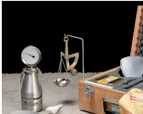
Misura di umidità di massetti in Mapecem con igrometro a carburo
