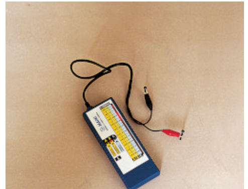
Misura di umidità di massetti in Mapecem con igrometro elettronico MAPEI
