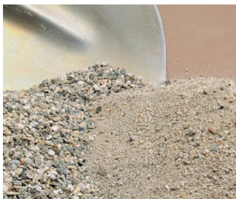
Inerti per Mapecem ghiaietto, da 4 a 8 mm - sabbia da 0 a 4 mm
