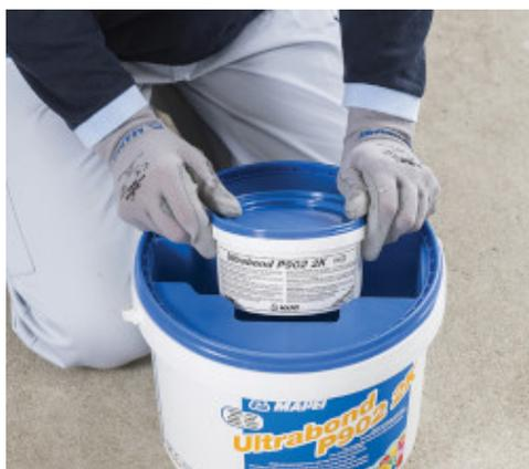
Rimozione del componente B
