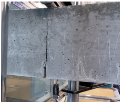
Prova di flessione in controllo di CMOD in accordo alla norma EN 14651
