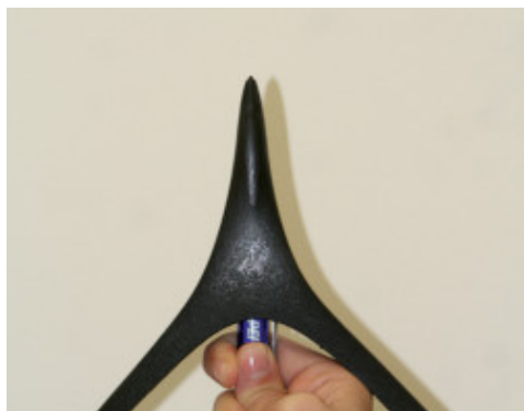
Prova empirica della resistenza a punzonamento e della elevata elasticità di Plastimul 2K Reactive
