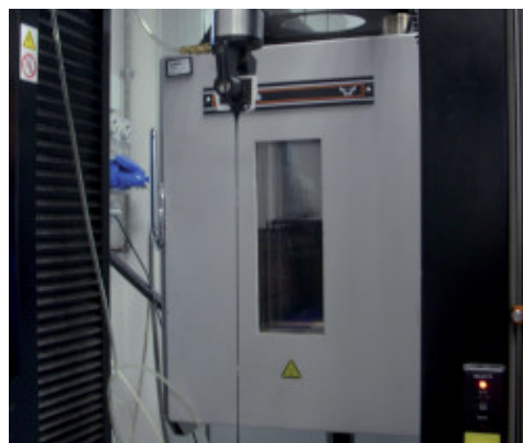
Massima corsa del dinamometro senza osservare la rottura del provino
