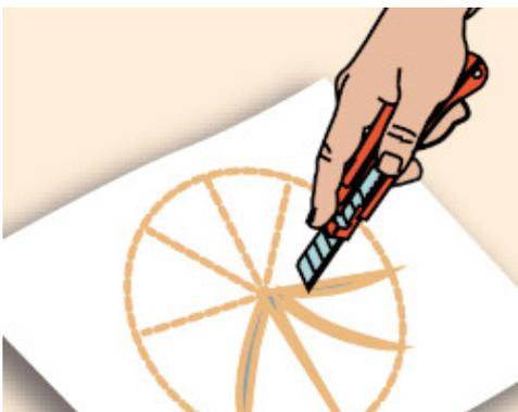
Figura 1 - Primo pezzo di Mapeproof SA su cui aprire apertura del diametro del corpo passante
