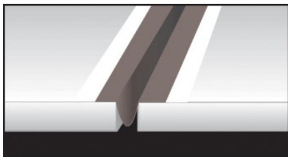
Posizionamento a omega di Mapeband PE 120 all'interno del giunto di dilatazione
