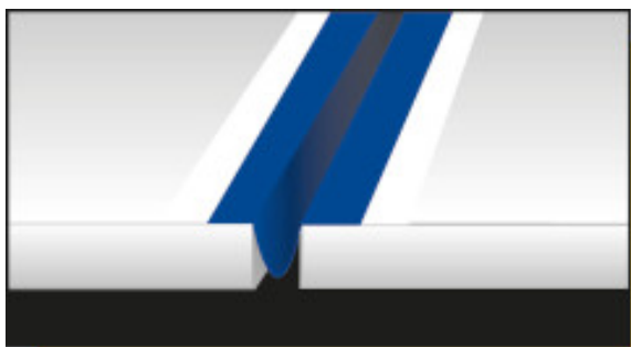
Posizionamento a omega di Mapeband all'interno del giunto di dilatazione
