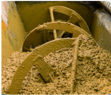
Confezionamento del calcestruzzo architettonico con Color Paving Admix
